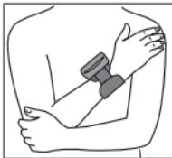
Pentru a obține măsurători exacte, toate tensiometrele de tip brătară trebuie poziționate la nivelul inimii. Exemplu: Dacă aparatul este poziționat la 20 de cm sub nivelul inimii, aşa cum este prezentat în figura din stânga (de exemplu, atunci când așezați brațul pe masă), valoarea indicată în urma măsurării va fi mai mare cu aproximativ 15 mmHg.
